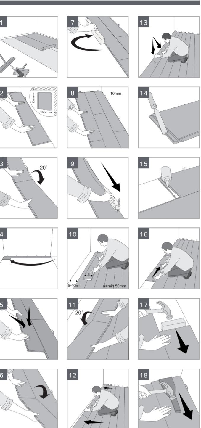
Moland Vinyl Wideplank lagt som svømmende gulv. Bryd ikke emballagen før gulvet skal lægges. Opbevar gulvet ved 20°C og en normal relativ luftfugthid (RF) på 35–65 % i min. 2 døgn inden lægning. I nybyggeri må emballeret Moland gulv ikke opbevares direkte på nye støbte gulv. Læg pakkene på strøer. Læs hele anvisningen inden lægning.
